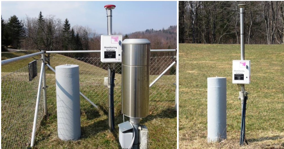
Slika 78: Opazovalni točki GPS nadzora stabilnosti območja odlagališča Boršt
