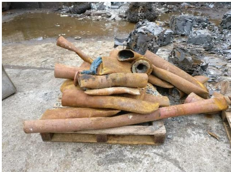
Slika 92: Odpadne industrijske cevi z notranjo oblogo (Foto: ZVD d. o. o.)
