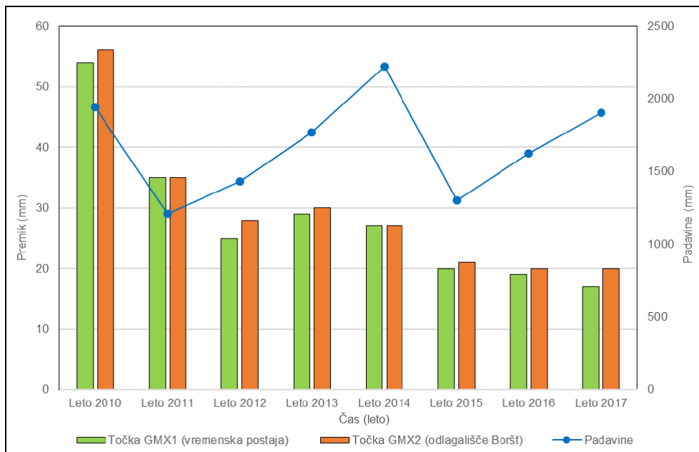
Slika 77: Horizontalni premiki nadzornih (geodetskih) točk GMX1 in GMX2, obdobje 7. april 2010 - 31. december 2017
