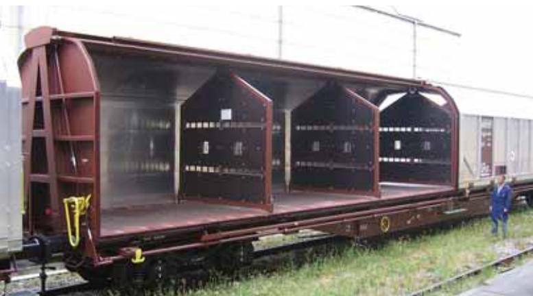
Prečna namestitve pomičnih pregradnih sten.
