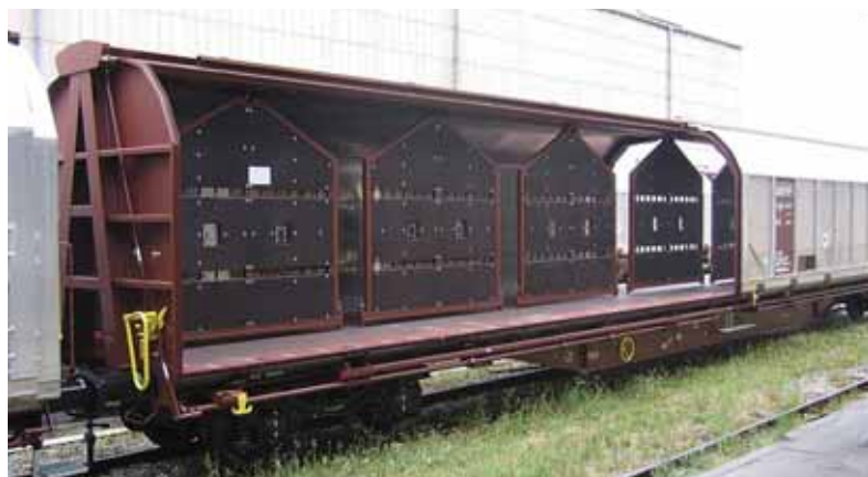
Vzdolžna namestitve pomičnih pregradnih sten.
