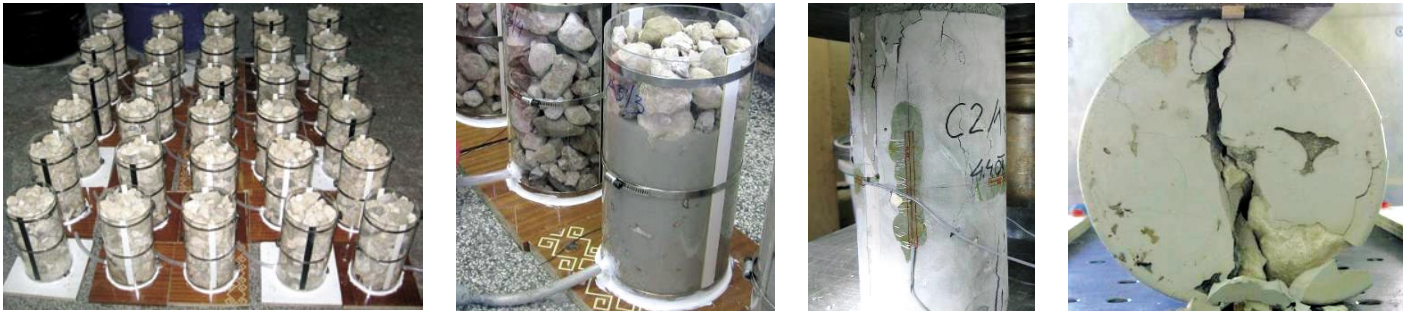
Slika 4 • Z leve: preskušanci, pripravljeni za injektiranje, injektiranje preskušanca, tlačna preiskava, cepilna natezna preiskava
