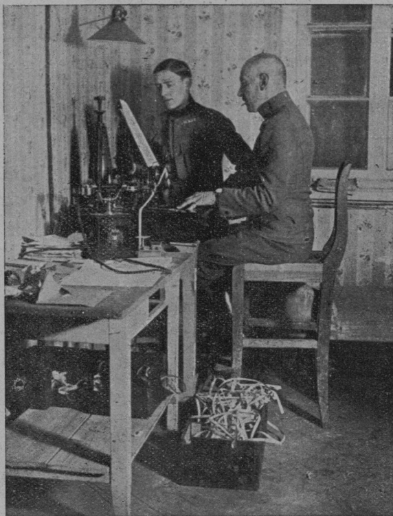
Naši telegrafisti: Hughesov aparat, ki brzojavlja naravnost tiskane črke v latinici; Morsejevi aparati brzojavljajo le črte in pike.
