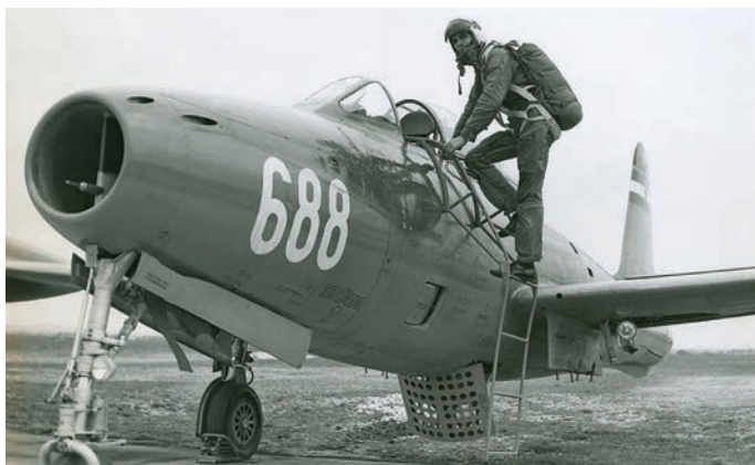
V letalo thunderjet 10688, 82. abr. iz Cerklj ob Krki, se po stopnicah v kabino vzpenja pilot Lazar Mijokovič. Stopnice, na katerih stoji Lazar, so uporabljali za vstopanje v kabino letala T-33 /TV-2 in le redko pri thunderjetih. (Foto: arhiv Marka Ličine)
