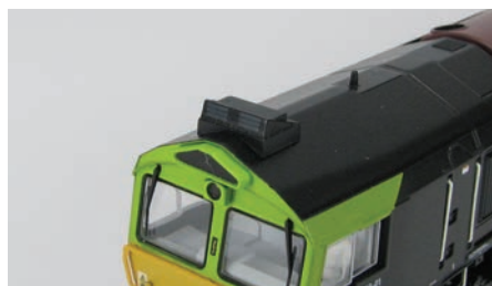
Modeli novejših lokomotiv imajo na kabinih vgrajene klimatske naprave.
