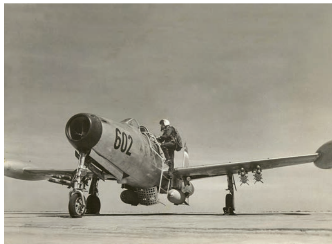
Izvidniški thunderjet s polno oborožitvijo ima pod krili obešene 454-kilogramske bombe (1000 lbs) ter rakete HVAR. Pod trupom za prvim kolesnim prostorom se vidi zaščitno ohišje izvidniške foto-kamere. (Foto arhiv Marijana Žerjela)
