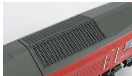
Rešetke nad hladilnim sistemom so kovinske (class 66).
