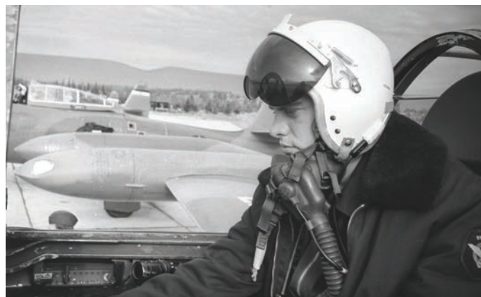
Pilot v izvidniškem thunderjetu RF-84G, fotografiran v Mostarju junija 1969. Na sliki se vidi rezervoar za gorivo z nameščeno kamero K-24. Kamera se je v ohišju lahko obračala okoli vzdolžne osi rezervoarja in tako snemala pod različnimi koti. (Foto via Mario Hrelja)
