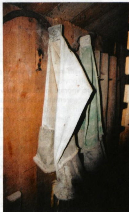
Različna sita v Lukovem mlinu - v ospredju iz blaga izdelani "pajkli", v ozadju lesena sita, kamor se iz skrinje vsiplje grobo mleto moka.
