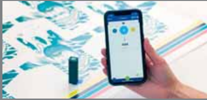
UV merilna naprava deluje prek mobilne aplikacije. (Slika: IST Metz)
