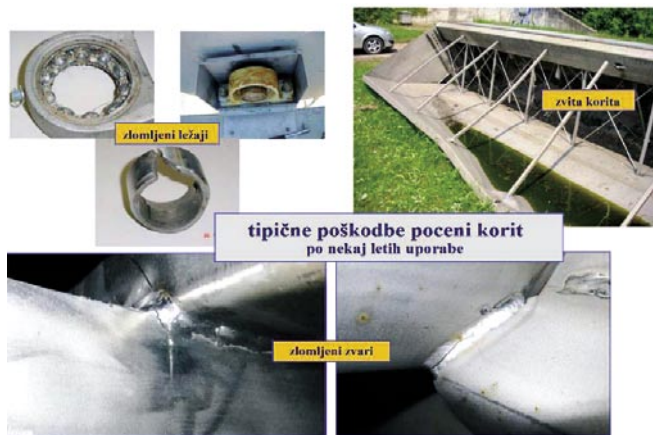
Slika 24 • Nekaj tipičnih okvar neakovostnih korit
