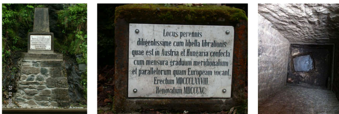
Slika 10: Avstro-ogrski fundamentalni reper B. W. H. Nr. 147 oziroma FR-1049 (levo), napis na reperju (sredina) in zglajena plošča tonalita, ki predstavlja fundamentalni reper (desno) (vir: Geodetska uprava Republike Slovenije in Geodetska družba d.o.o.)
