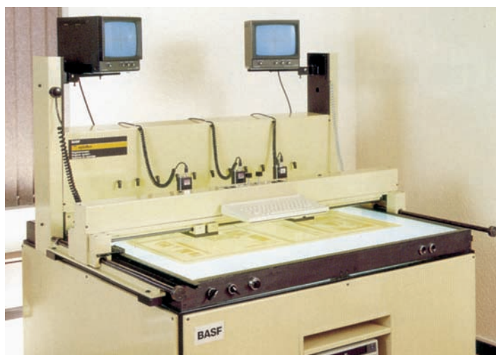
Slika 30. Izdelave tiskovne forme s postopkom Nyloflex.
