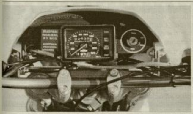
Med voznikom: majhen merilnik hitrosti, ključavnica, pet kontrolk in opozorilo o »pitju« bencina.
