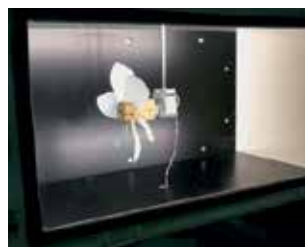
Slika 8: Klasična radialna vetrnica.
