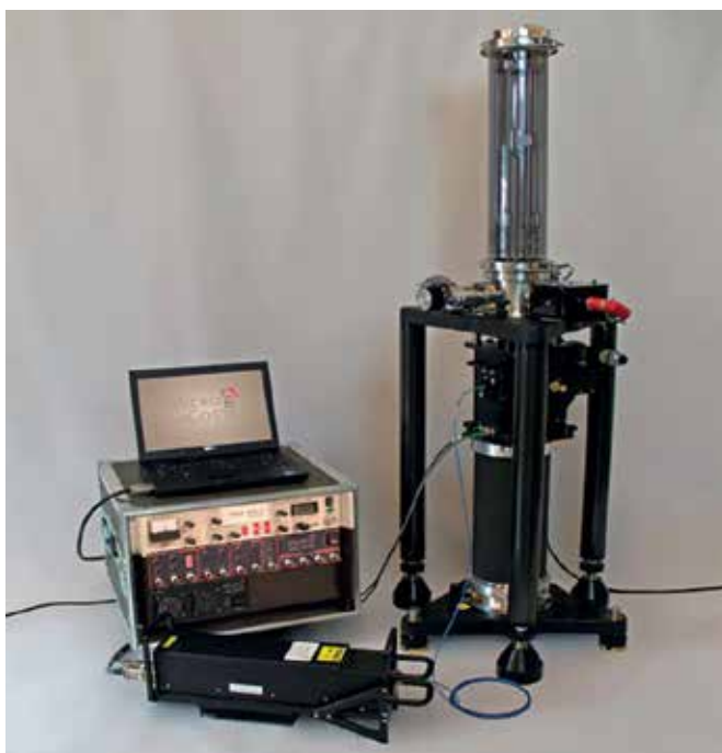
Slika 4: Instrument FG5-X podjetja Micro g LaCoste, ki z merjenjem padca ogledala meri težnostni pospešek g na izbrani lokaciji. (Vir: spletna stran Micro g LaCoste)
