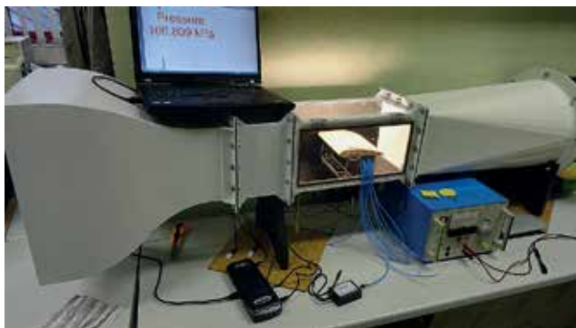
Slika 16: Merjenje tlaka na krilu.
