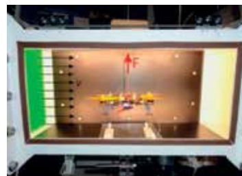
Slika 19: Vpliv vodoravnega toka v merilni komori.
