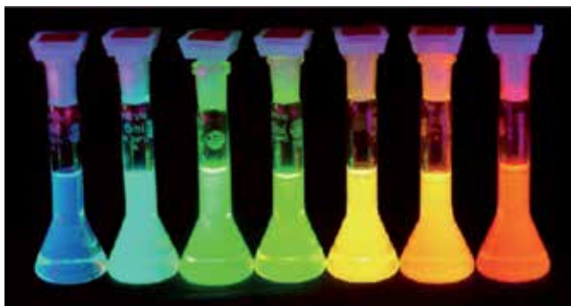
Slika 3: Koloidne suspenzije nanokristalov kadmijevega selenida pri obsevanju s kratkovalovno svetlobo fluorescirajo v barvah, katerih valovna dolžina narašča z naraščajočo povprečno velikostjo od 2 do 7 nanometrov.
