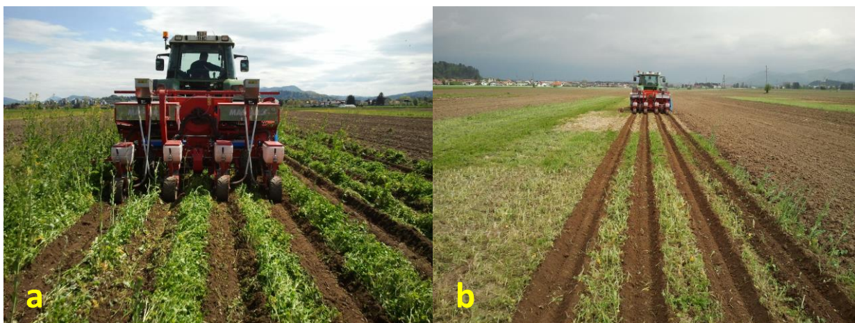
Slika 14: Direktna tračna setev v dosevke (a) in tračna setev v predhodno zmulčeno površino (b)
