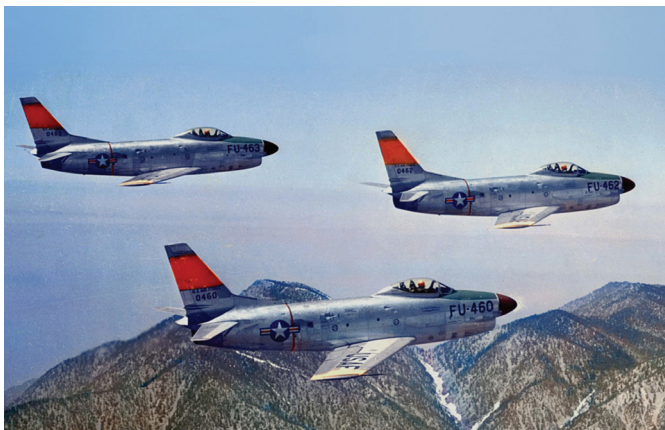
Slika v zraku kaže prvih nekaj izdelanih letal v prvi seriji F-86D-1. Letalom so pobarvali smerne stabilizatorje s fluorescentno oranžno barvo, da bi izboljšali njihovo vidljivost v zraku. Letala so služila v testni enoti. (Foto: USAF)
