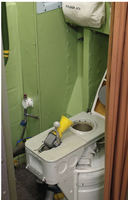
Vesoljsko stranišče na Miru. Deluje s pomočjo podtlaka, s katerim ločeno zbirajo urin in blato. Za urin uporablja vsak član odprave svoj nastavek. Na voljo je tudi več vrst papirja.
