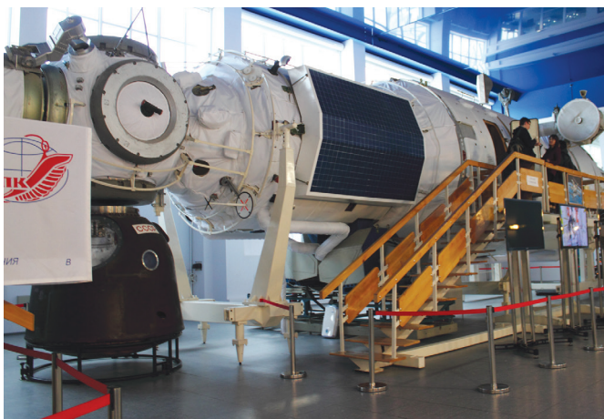
Glavni (bazni) blok ali modul Mira. Na sredini so zložene plošče fotovoltaičnih celic kot ob izstrelitvi, desno antena, levo del s kar petimi združevalnimi mehanizmi, skrajno levo del združenega modula in spodaj pravi pristajalni odsek transportne vesoljske ladje sojuz.
