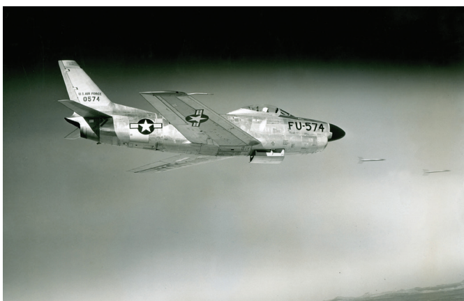
Letalo 50-574 med izstrelitvijo raket. Zabojujnik z raketami se je odpiral in zapiral zelo hitro. Za odpiranje je potreboval 0,5 sekunde, vseh 24 raket pa je lahko izstrelil v 0,2 sekunde. Praksa je pokazala, da je za največjo verjetnost zadetka bilo treba izstreliti vseh 24 raket hkrati. (Foto: arhiv avtorja)
