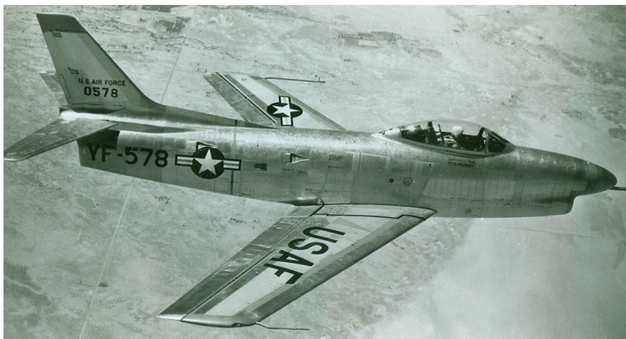
Drugi prototip YF-86D 50-578. Zaradi naglice pri razvoju so zadnji del letala povzeli po letalu F-86C/YF93A sabre, ki so ga nameravali razviti v lovca za globoke prodore nad sovražno ozemlje. Letalo radarja še ni imelo vgrajenega, pa tudi kabina se je odpirala nazaj kot pri osnovnem modelu F-86. (Foto: arhiv avtorja, foto-razglednica)
