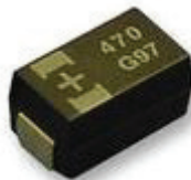
Oznake na tantalnem kondenzatorju. Črta označuje pozitiven priključek (tudi če znak + ni izpisan).
