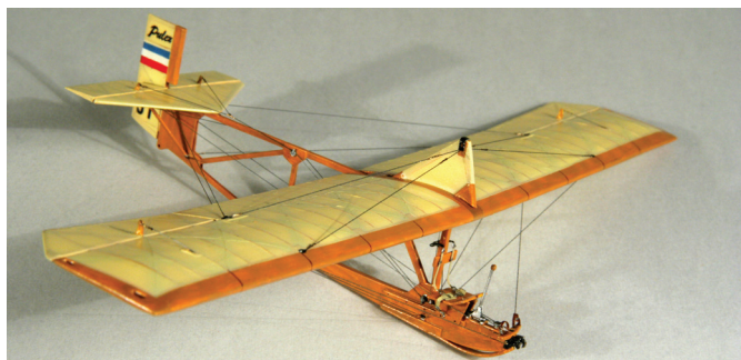
Končana maketa zöglinga 33. Letala tega tipa so imela krila v celoti utrjena s pletenicami, zato je nad krili tudi trikotnik.
