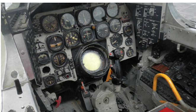
Kabina letala F-86D, posneta v MAPS Air Museum North Canton. Na spodnji strani armaturne plošče je bil zaslon, ki je prikazoval radarski signal in zapleteno simboliko znakov, ki jih je moral spremljati pilot, ko je usmerjal letalo proti cilju. Prikazovalnik je imel ponavadi nataktnjeno še gumijasto manšeto, ki je omogočala zasenčenje in gledanje tudi ob dnevni svetlobi. (Avtor: Wilson44691, Wikipedija.)
