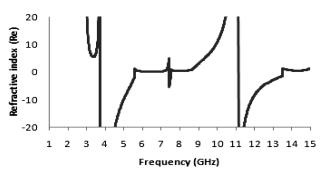
**Figure 4:** Real magnitude of refractive index ( $\eta$ ) versus frequency **Slika 4:** Realni obseg lomnega količnika ( $\eta$ ) v odvisnosti od frekvence
