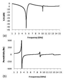
**Figure 5:** a) Transmission coefficient  $(S_{21})$  for the unit cell on the Rogers 6010 substrate material, b) real magnitude of permittivity ( $\varepsilon$ ) against frequency for the unit cell on the Rogers 6010 substrate **Slika 5:** a) koeficient prenosa  $(S_{21})$  osnovne celice na podlagi iz materiala Rogers 6010, b) realna magnituda dielektrične konstante ( $\varepsilon$ ) v odvisnosti od frekvence osnovne celice na podlagi iz Rogers 6010
