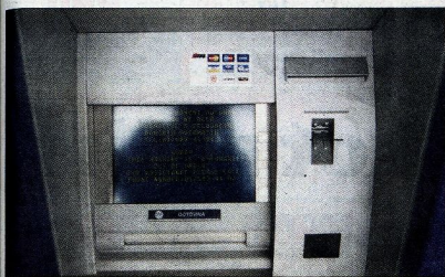
Banomat z namešnitima območjema oziroma napravo za prikrito branje bankniških kartic (desno pokončno ob monitorju) in napravo za snameanje tipkovnice na bankomatu (vzdolžno nad monitorjem)
