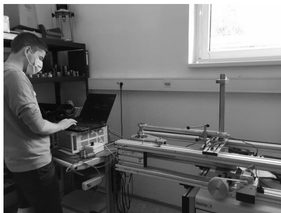
Slika 7: Avtomatiziran sistem za kalibracijo momentnih ključev
