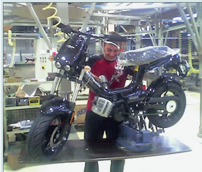
Montaža motorjev (TOMOS). Deset samodejno višinsko prilagodljivih delovnih mest. Zvezno premikanje obešal z izdelki in z regulacijo hitrosti pomikanja.
