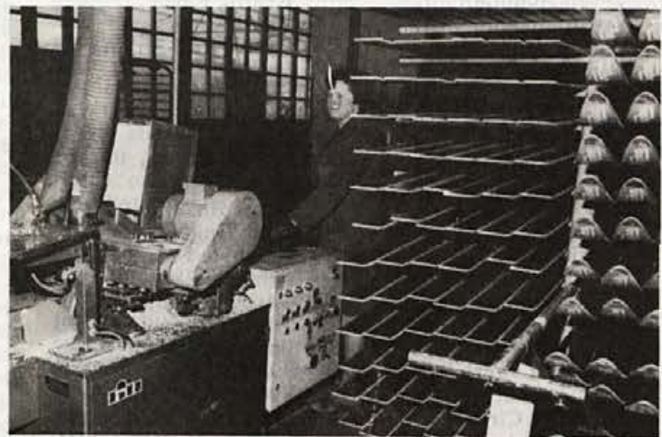
Strojno odkrivanje zgornjih robnikov
