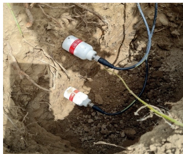
Vstavljene sonde za spremljanje vlažnosti tal na dveh globinah (Foto: B. Naglič)
