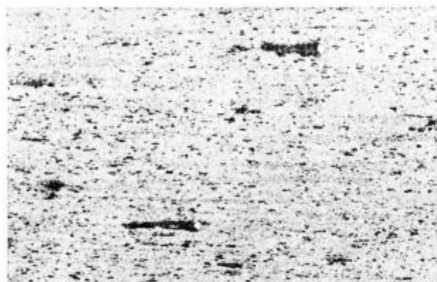
Slika 15 x 200, valjano pri 945 °C, redukcija ca. 35 %, temperatura trganja 600 °C
