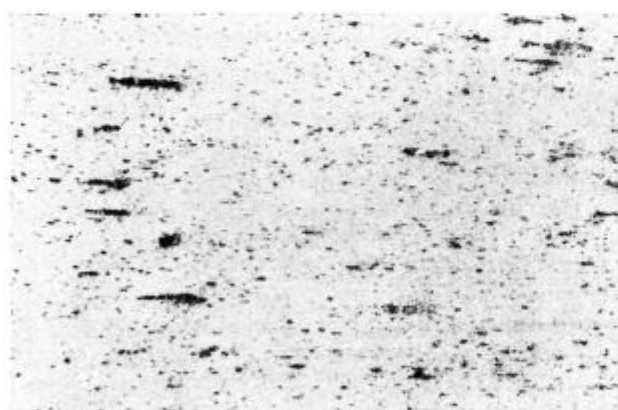
Slika 16 x 200, valjano pri 860 °C, redukcija ca. 35 %, temperatura trganja 600 °C
