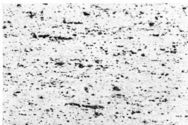
Slika 18 x 200, valjano pri 600 °C, redukcija ca. 35 %, temperatura trganja 600 °C
