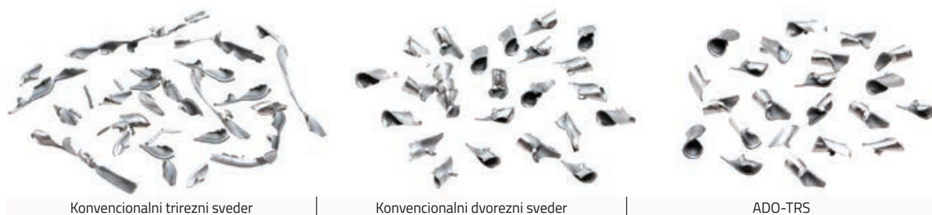
» Slika 4: Primerjava oblike odrezkov pri obdelavi materiala SS440 (orodje: ADO-TRS-5D, premer: Ø 16, rezalna hitrost: 80 m/min (1592 vrt./min, pomik: 1.019 mm/min (0,64 mm/vrt.), globina izvrtine: 50 mm (skozi), hladilna tekočina: vodotopna, horizontalni obdelovalni center (HSK-A 63)).
