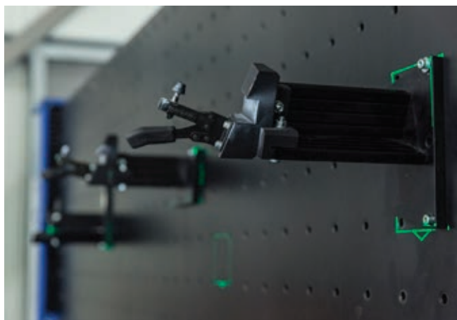
» Elementi kontrolno merilne naprave nameščeni znotraj laserskih projekcij na plošči kontrolno merilne naprave. Vir: topometric
