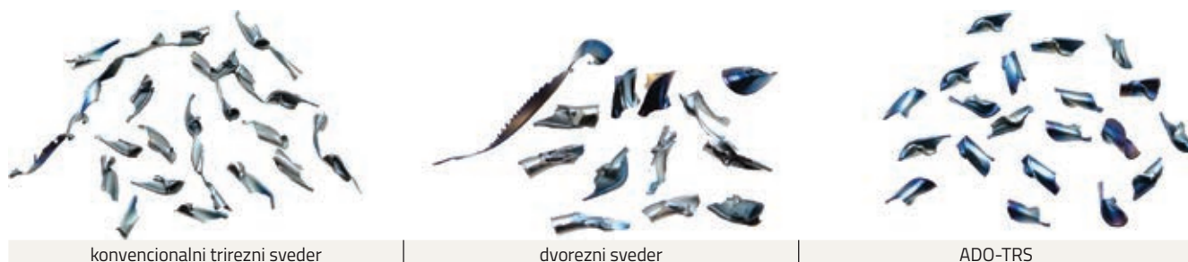
» Slika 2: Primerjava oblike odrezkov pri obdelavi materiala SCM440 (orodje: ADO-TRS-5D, premer: Ø 16, trdota obdelovanca: 82–90 HB, rezalna hitrost: 80 m/min (1592 vrt./min, pomik: 1019 mm/min (0,64 mm/vrt.), globina izvrtine: 50 mm (skozi), hladilna tekočina: oljna megla (2–3 cm 3 /h), horizontalni obdelovalni center (HSK-A 63)).
