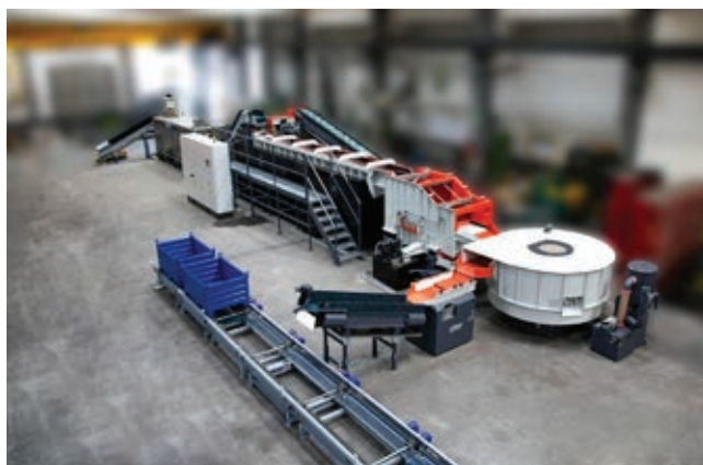
» Povsem avtomatizirani sistem za odstranitev olja in pranje je neposredno povezan s stiskalnico ter omogoča nepretrgano podajanje. Edina ročno izvedena operacija je zamenjava polnih transportnih posod vsakih nekaj ur.
