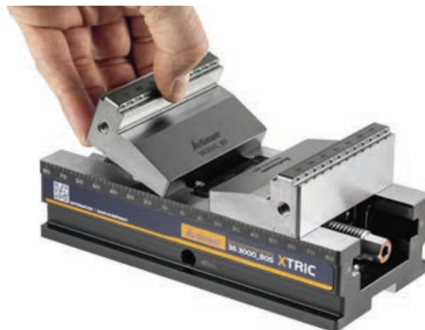
» Enostavno vstavljanje čeljusti z zaskočnim mehanizmom GARANT Xtric in sistem za hitro menjavo čeljusti zagotavljata enostavno menjavo brez uporabe orodij. Vir: Hoffmann Group
