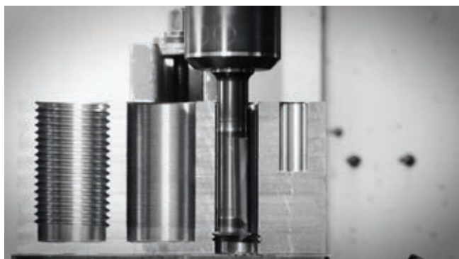
» Stebelne navojne rezkarje Walter lahko sestavimo individualno za vsako stranko na osnovi standardnih orodij. Slika: Walter AG
