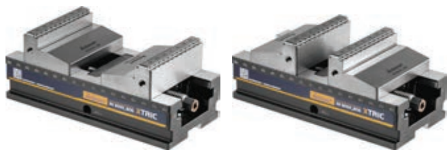
» Novi centrirni primež GARANT Xtric omogoča zelo veliko območje vpenjanja, s tem ko se čeljusti lahko obrnejo za 180 stopinj. Vir: Hoffmann Group
