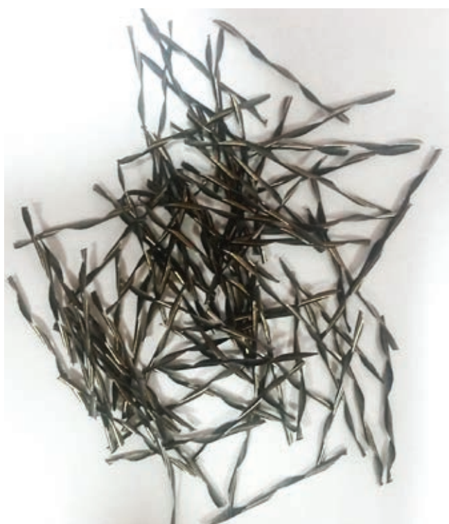
» Slika 3. Odrezki, nastali pri izbiri neustreznih rezalnih parametrov [6]
