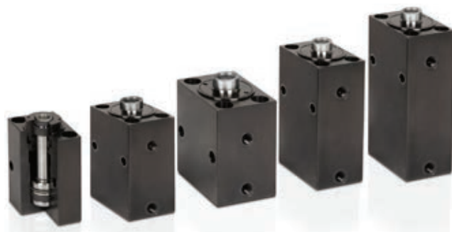
» Pri blokcilindrih S je na razpolago pet različnih velikosti s premeri batov 32 do 80 mm, štiri dolžine hodovod 25 do 100 mm in pet različnih sistemov tesnenja (Slika: ROEMHELD).
