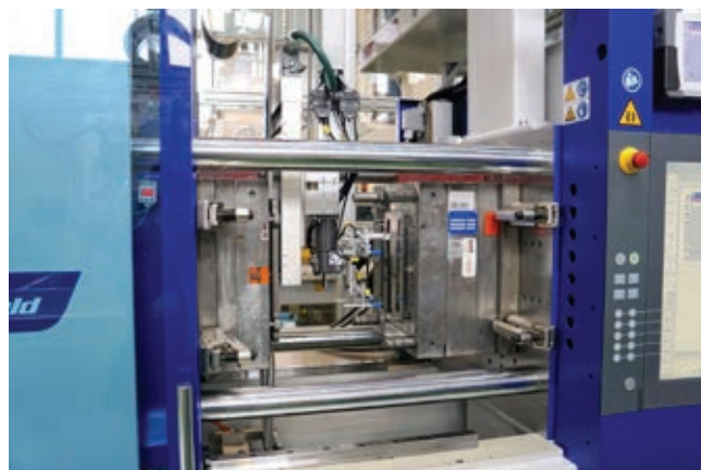
» Sl. 4: Obe brizgalki sta opremljeni s podajalnima enotama valj-valj. Robota prenašata ploščo za segrevanje folije in na nasprotni strani prisesek za odstranjevanje gotovih kosov.
