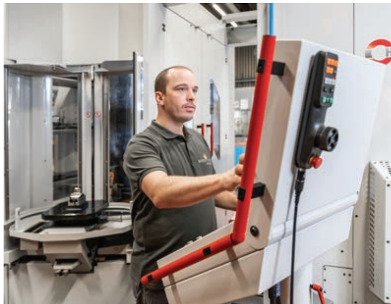
» Krmilnik stroja Hermle C 42 U dobavlja podjetje Heidenhain (tip TNC 640) in je v celoti digitalen po zaslugi vmesnika HSCI ter vmesnika EnDat. Vir: Hermle
