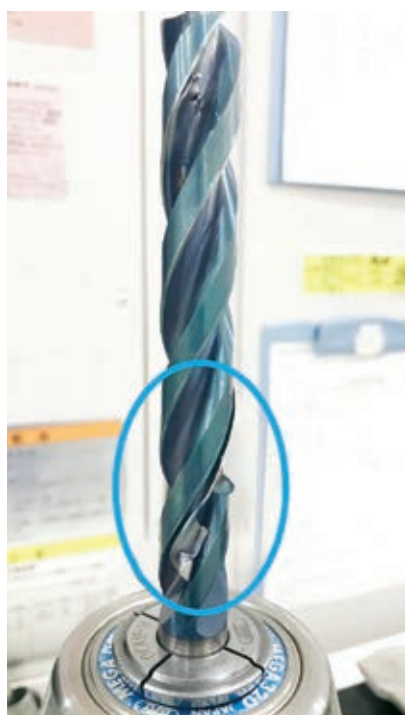
» Slika 3: Pri konvencionalnem trireznem svedru na vijačnici zastajajo odrezki vrtnja v SCM440.
