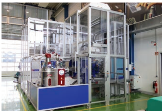
» Sl. 3: KURZ je povečal svoje aplikacijske/tehnološke kapacitete z nakupom dveh proizvodnih celic »vse v enem« na podlagi brizgalk SmartPower z zapiralno silo 2.100 in 1.200 kN.
