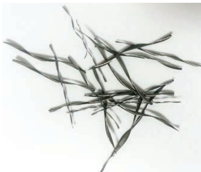
» Slika 2. Odrezki, nastali pri izbiri ustreznih rezalnih parametrov [6]
