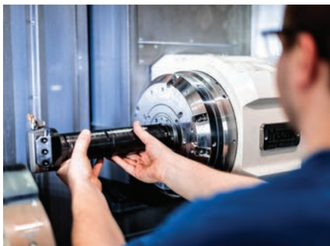
» Vpenjanje orodja v vreteno stroja Integrex i-500
