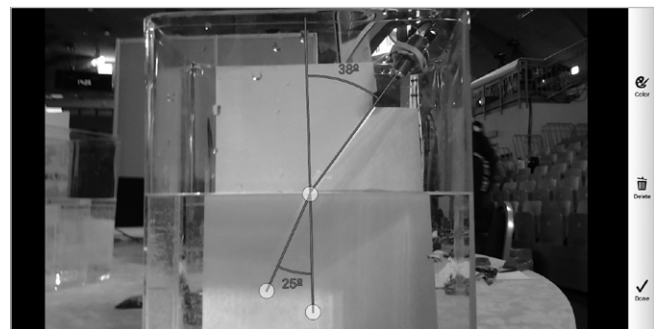
Slika 3: Merjenje vpadnega in lomnega kota na fotografiji z aplikacijo na tabličnem računalniku
