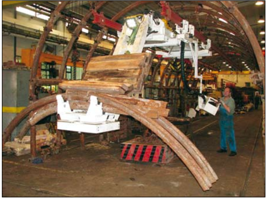
Slika 8. Testiranje podajalnika lokov v hčerinskem podjetju HTZ Velenje, d. o. o.
