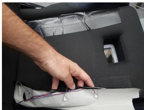
Slika 3. Integracija taktilnega izhodnega uporabniškega vmesnika v sedalo simulatorja vožnje (traka piezoelektričnih aktuatorjev na levi in desni strani sedala).
