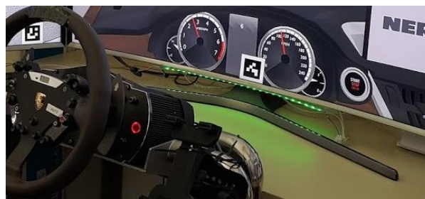
Slika 4. Integracija vizualnega uporabniškega vmesnika v simulator vožnje (LED trak pod osrednjim zaslonom).
