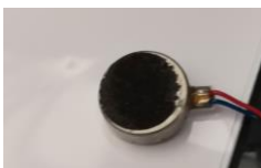
Slika 1. Vibracijski motor v taktilnem vmesniku.
