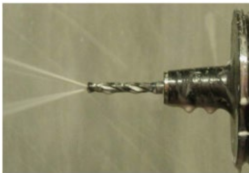
Slika 6: Visokotlačno dovajanje hladilno mazalne tekočine skozi sveder Vir: lasten.
