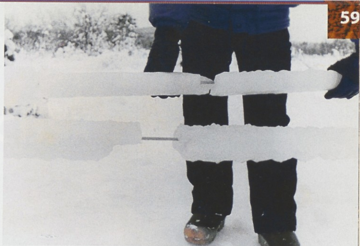
Popolnoma uničim visokonapetostni daljnovodni steber in več kot deset centimetrov debel žled na električnem vodniku (Brkini, 1980)
