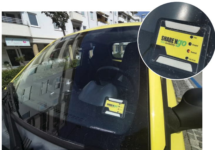
Elektronska naprava za vetrobranskim steklom prikazuje, ali je vozilo prosto, zasedeno, rezervirano ali ne obratuje. Na sliki – rezervirano.
