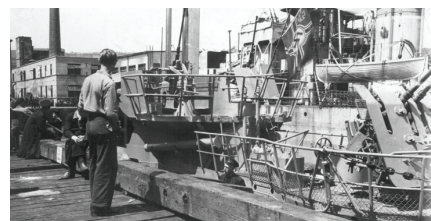
Most podmornice s posebno oznako v obliki osemkrake zvezde in malo svastiko, ki je bila očitno narisana s kredo. Radar in protiletalska oborožitev nista več v izvorni obliki.
