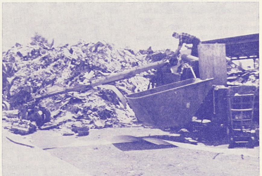
Polomljeno dvigalo mariborske stiskalnice, ki mu je inšpektor dela prepovedal obratovanje
