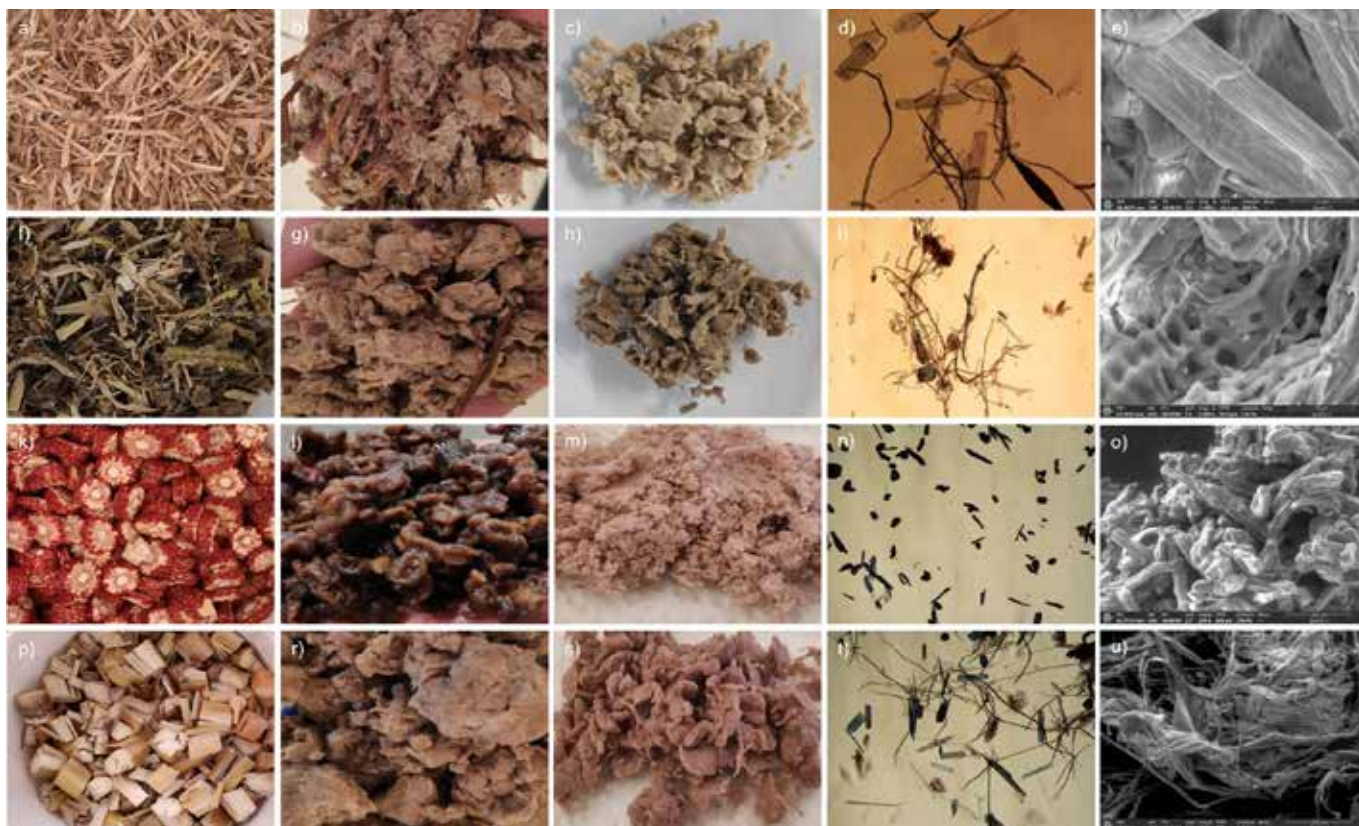
Slika 2: Biomasa (1. stolpec), neobdelana pulpa (2. stolpec), izolirana celuloza (3. stolpec), optične (4. stolpec) ter SEM mikroskopske slike (5. stolpec) celuloze izolirane iz pšenične slame (1. vrsta), koruzovine (2. vrsta), olušenih koruznih storžev (3. vrsta) in koruznih stebel (4. vrsta). Figure 2: Biomass (1. column), untreated pulp (2. column), isolated cellulose (3. column), optical (4. column) and SEM microscopic images (5. column) of cellulose isolated from wheat straw (1. line), corn stover (2. line), peeled corn cobs (3. line) and corn stems (4. line).
