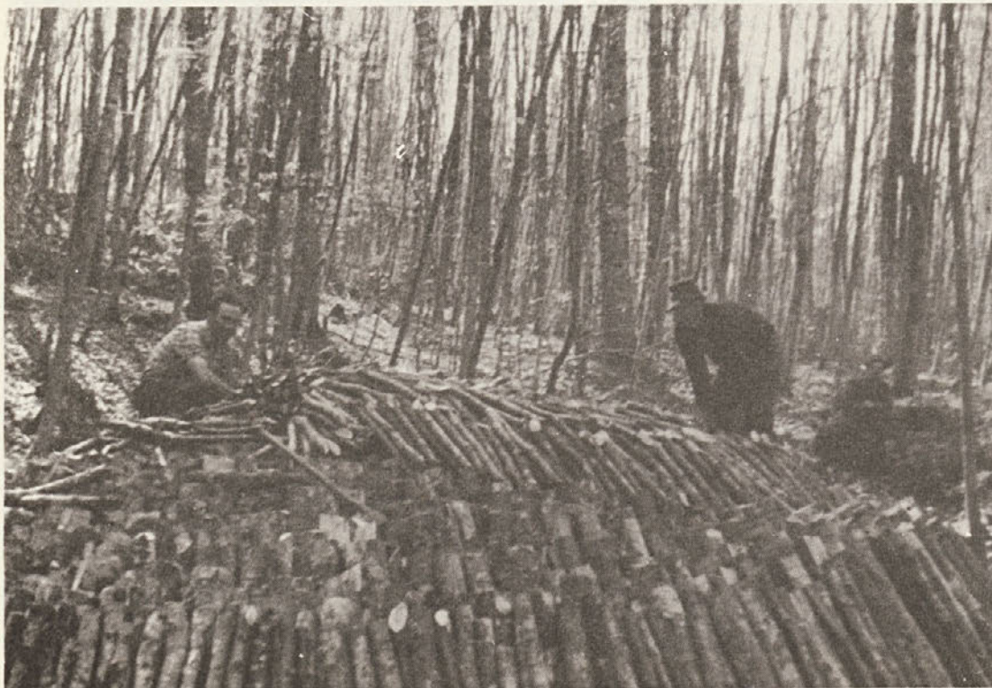
Zlaganje kope za kuhanje oglja na Brezovi rebri odd. 17 a. Na sliki Stane Pirc, star., in Andrej Rustja – leta 1960. (Foto ing. Jože Kure)
