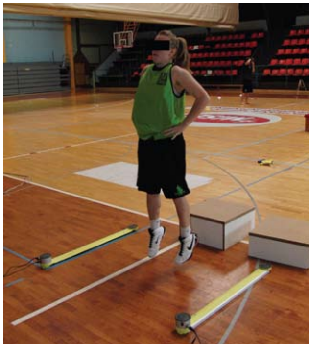
Slika 10: Merjenje vertikalnega skoka s sistemom Optojump pri košarkaricah (košarkarski tabor evropske federacije Fiba Europe, Postojna 2010)
