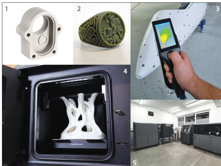
Na sliki: 1. Ohišje ležaja (MBJ), 2. Voščeni pramodni za kalup (DLP), 3. Skeniranje letalskega trupa, 4. Organska oblika iz PLA (FFF), 5. 3D tiskalni studio Solid World d.o.o. v Radomljah.
