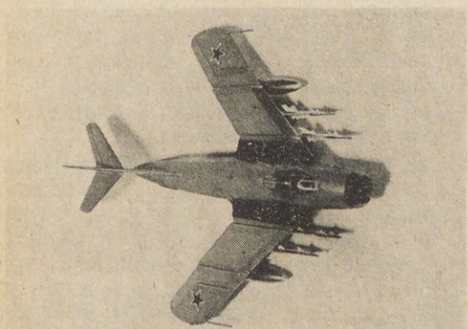
Slika 6. Nesvetleči črni smrček in črni sprehajalni premaz na krilih popestrta povsem srebrno letalo.
