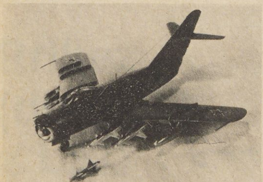
Slika 7. Proizvajalci maket le redkokdaj ponudijo točne posnetke dodatne oborožitve. Ročno izdelana raketa je na letalu, pred njim pa leži raketa iz makete Hasagarva.
