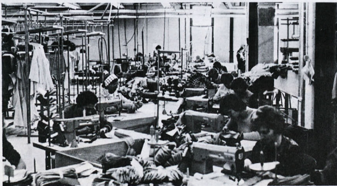
Pogled na brigado šivanja v TOZD Delta Ptuj. Ta TOZD je edina, ki ima v srjačarski proizvodnji speljan proizvodni trak po visečem sistemu — (Foto: arhiv Labod)
