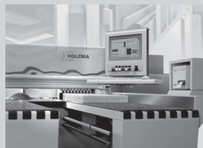
□ Slika 7. Holzmin CNC stroj za krojenje plošč Optimat HPP 250
