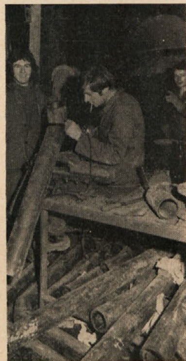
Spajkanje gumijastih cevi v obratu titanovega dioksida.
