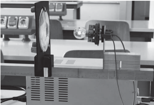
Slika 1. Ker je pod žarilno nitko narisana navpična črta na optični klopi, so meritve razdalje med predmetom in sredino leče zelo natančne. Na nosilcu je leča. Ravnina, ki poteka skozi sredino leče, je podaljšana in narisana kot črta na nosilcu. Leča je le zaradi fotografiranja blizu žarnice, v resnici je vselej vsaj pol metra stran.
