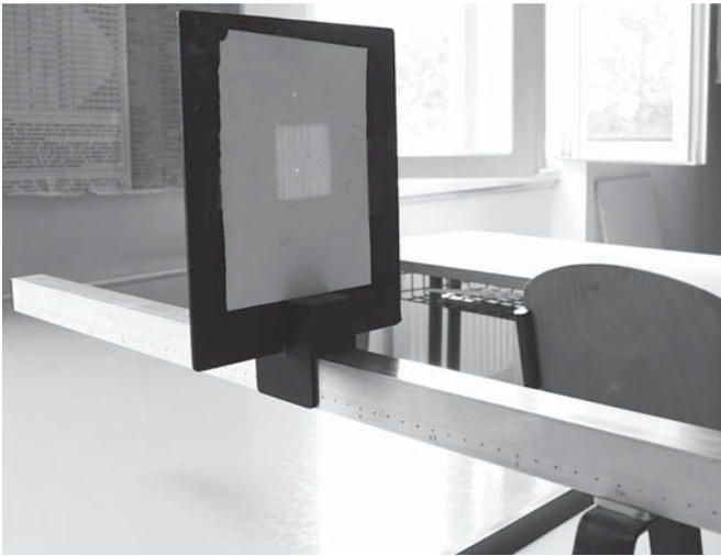
Slika 3. Ko ustvarjamo pomanjšano sliko, nastaneta na zaslonu dve sliki žarilne nitke. Tudi na nosilcu zaslona je narisana navpična črta za natančno merjenje.
