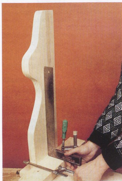
Slika 2. Da bo stik zgornje police in stranic res pravokoten, si pomagajte s kotnikom in dvema majhnima mizarškima svorama.
