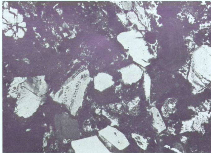
Sl. 12. Vrtina 1/61, Mala Pirešica, vz. 41/7 242, gl. 150,20 m, nikola +, 35 ×. Andezitni kristalo- in litoklastični tuf. Šte- vilni so kristali plagioklaza ter mikrokrystalni litoklastični fragmenti
