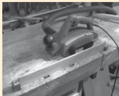
□ Slika 1. Skobljčič Iskra SK 282 na skobeljniku in preskusna letve natančnosti nastavitve rezil
