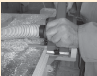
□ Slika 5. Izdelava brazde z uporabo prislona in omejlilca globine
