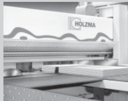
□ Slika 3. Novost: centralna kotna poravnalna naprava z regulacijo pritiska
