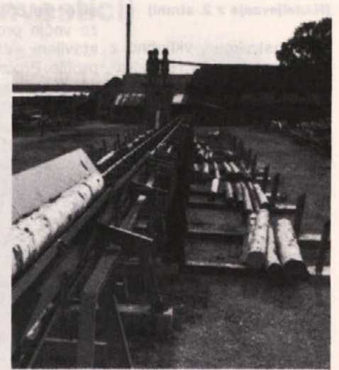
Pogled na sortirne bokse, kjer se hlodovina sortira v štirinajst različnih sortimentov.
