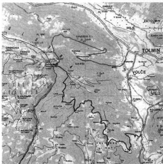
Cestni povezavi med Volčami in Solarji: zgoraj nova načrtovana cesta skozi Kamenco in prek Kolovrata, spodaj obstoječa slaba cesta, katere obnova bi bila cenejša od gradnje popolnoma nove ceste.
