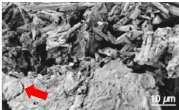
Slika 7: Delec polistirena pod elektronskim mikroskopom z vidno razpoko.
