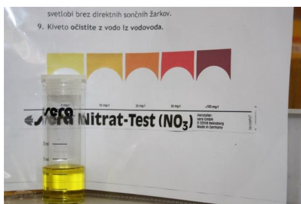
Slika 8: Primer kemijske analize določevanja nitratnih ionov v enem izmed vzorcev vode.
