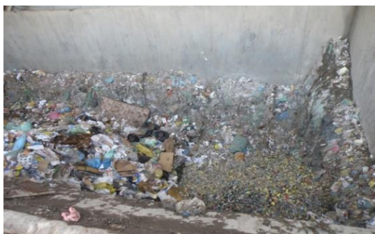
Slika 1: Sprejem MKO v sprejemni jašek obrata MBO skozi proces MBO [14]
