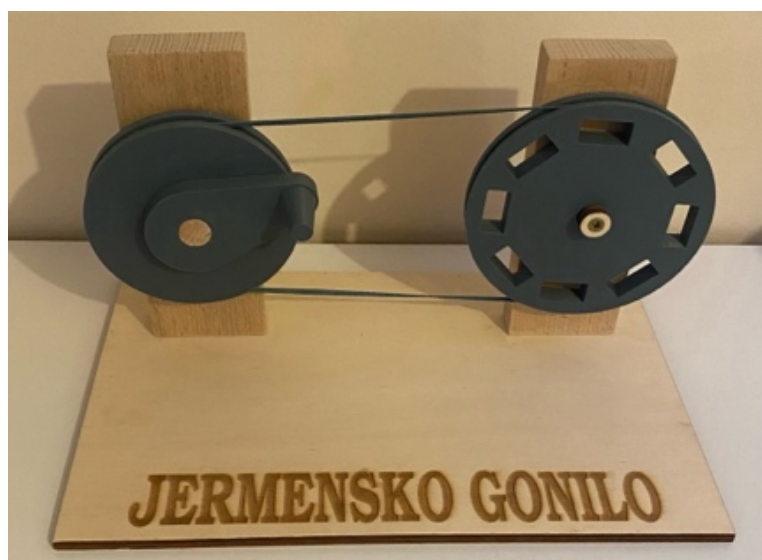
Slika 1: Končni izdelek – model jermenskega gonila.
