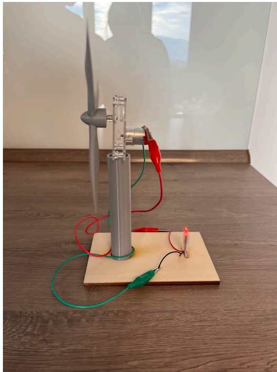
Slika 4: Končni izdelek – model vetrnice.
