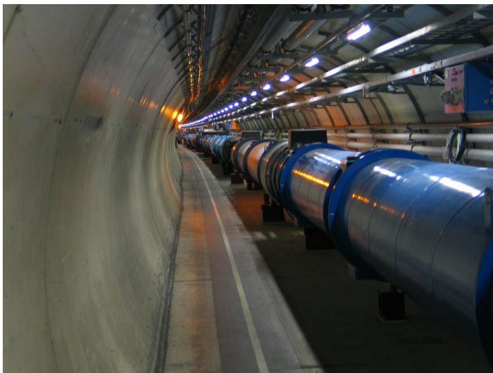
Slika 6. Odsek tunela s trkalnikom LHC. V notranjosti valjastih magnetov sta dve vakuumizirani cevi, po katerih v nasprotnih smereh krožijo protoni. Magnete od zunaj hladijo s tekočim helijem, hladilni sistem pa obdaja še izolacija (evakuiran sloj), ki preprečuje pritekanje toplote iz okolice.
