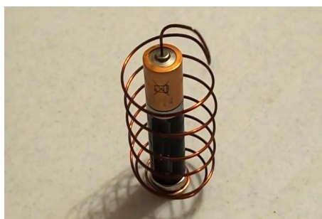
Slika 7. Dva primera izvedbe homopolarnih motorjev [9, 10]. Oba pola baterije predstavljata za žični sistem drsni kontakt. Magnetno polje ustvarja ploščni magnet pod baterijo. Tako kot pri motorju z vijakom na sliki 2 je pomemben magnetni navor na del vezja, ki je pravokoten na smer magnetnega polja (os vrtenja).
