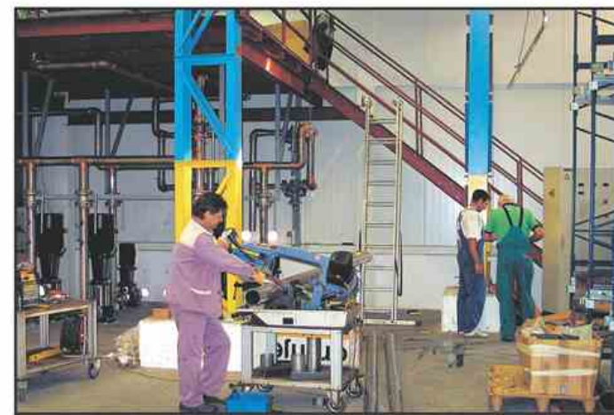
Tehnologija proizvodnje nove generacije pralnih in sušilnih strojev je zahtevna, plastiko obdelujejo pri natančno 8 stopinjah - na sliki montaža hladilne opreme.
