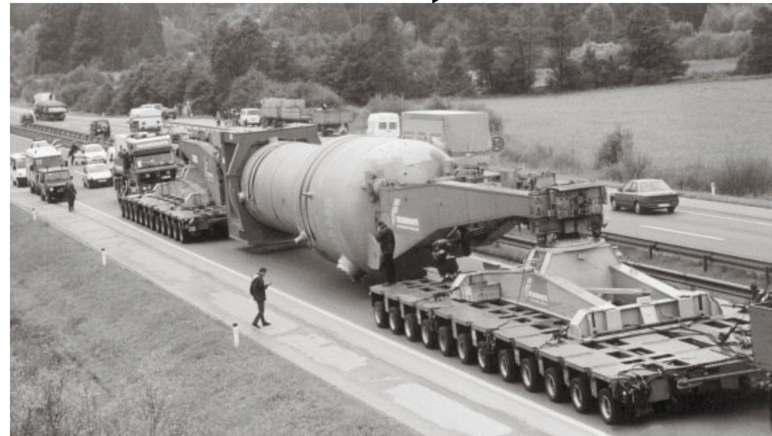
Konec avgusta in v septembru so vlačilci avstrijskega Felbermayerja dvakrat prepeljali 224 kilometrsko razdaljo od Kopra do Krškega, obakrat natovorjeni s 343 ton težkim in 20 metrov dolgim uparjalnikom. Prevoz stoletja je uspel brez večjih zapletov.
